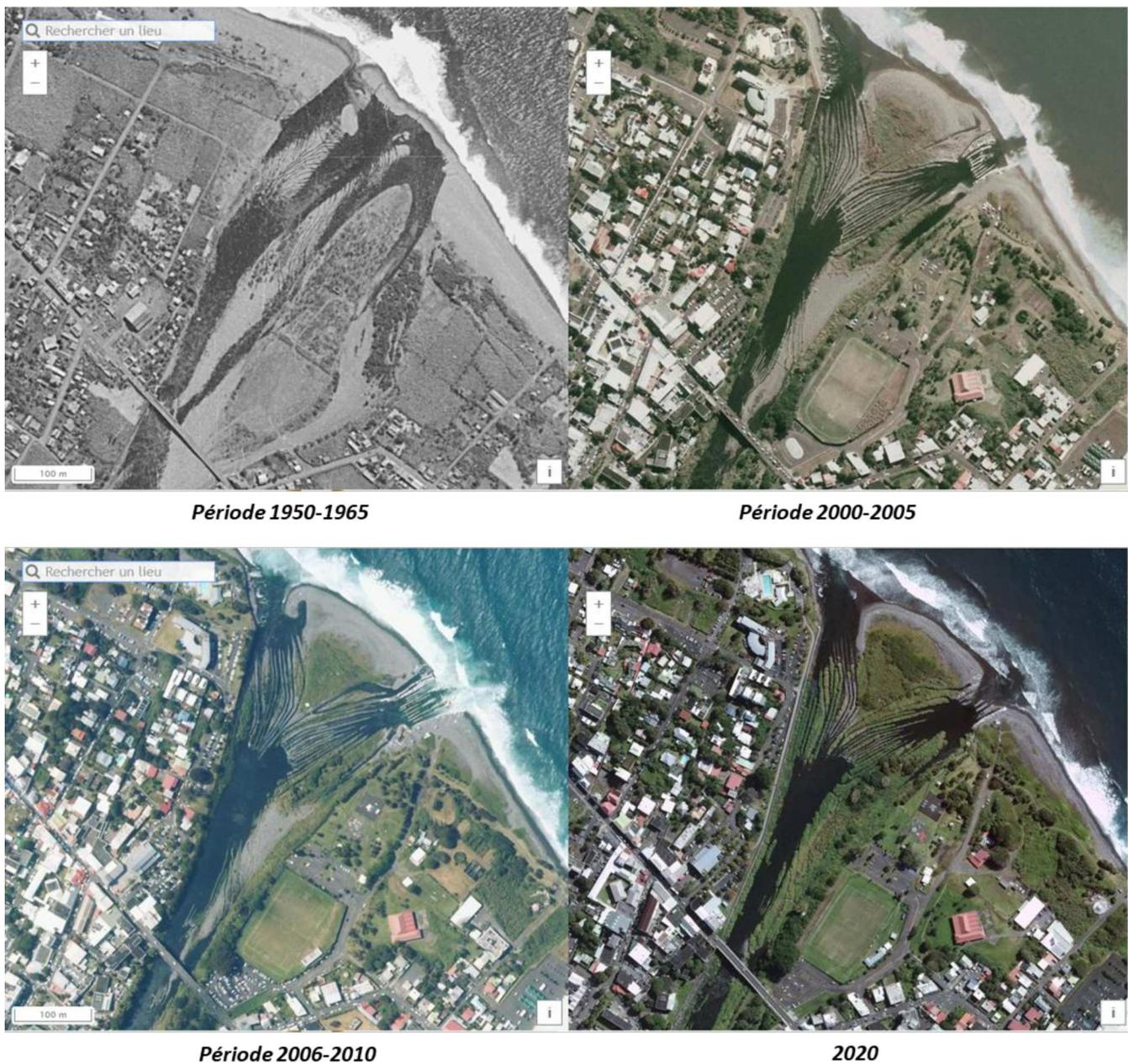
Figure 2: Evolution du lit de la rivière des Marsouins à l'embouchure entre 1950 et 2020 (Images IGN, <https://remonterletemps.ign.fr>).
